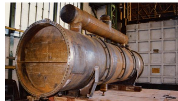
Spannungsarmglühen eines Wärmetauschers
