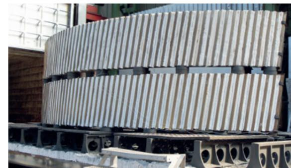
Zahnkranzsegmente aus Sphäroguss vergüten
